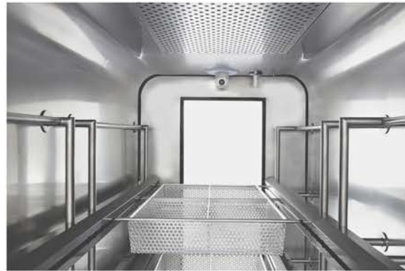
Interior de la cámara de transferencia
